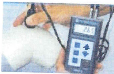
Fig. 19: Sensor de ultra-som para medição da espessura do tubo (Tecnomedição – Sistemas de Medição Ltda. Disponível em: < http://www.tecnomedicao.com.br/ >).
